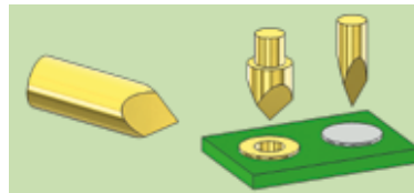
Треугольный ступенчатый (15,30,62) Для сквозных отверстий и площадок под пайку. Острые грани проникают через остатки флюса и слой оксида.
