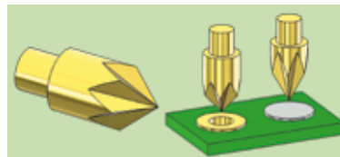
Шестиугольный (07,08) Для тестирования отверстий в платах и площадок. Острые грани проникают через загрязнения и слой оксида.
