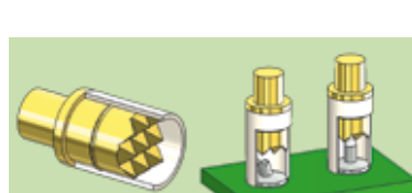
Рифлёный, W-образный профиль (06,46,64,66) Универсальный наконечник для контакта с проводами, выводами и штырьками навивку, подходит даже для изогнутых контактов.
