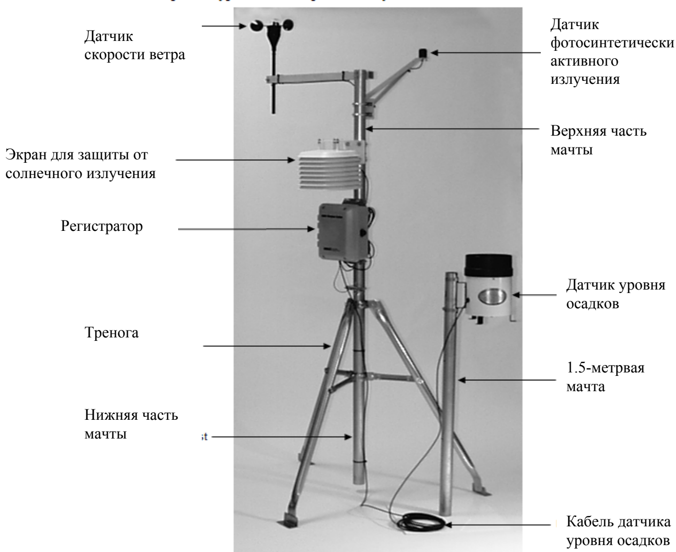
Рис.2.1. Общий вид метеорологической станции НОВО U30 при установке на треногу. Датчик уровня осадков установлен на дополнительную мачту. Обычно он устанавливается на верхнюю часть мачты. Датчик скорости ветра установлен на полуперекрёстный рычаг
